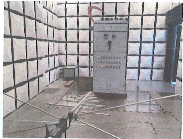
电场辐射发射试验布置图
