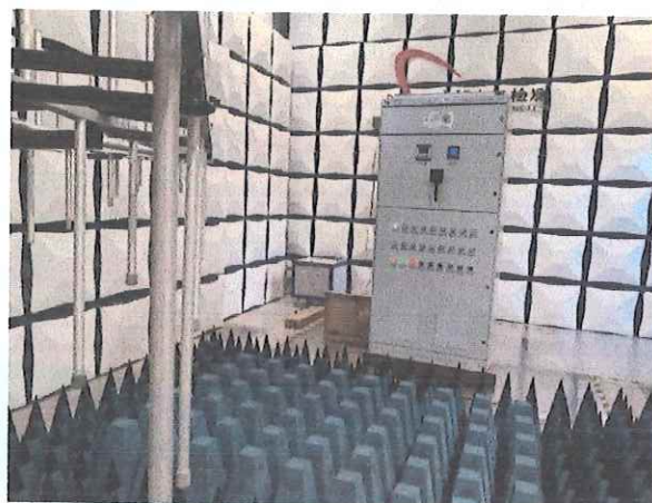
射频电磁场辐射抗扰度试验布置图
