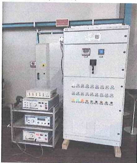
静电放电抗扰度试验布置图
