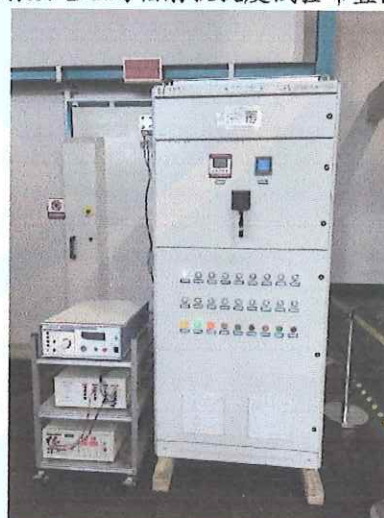
1.2/50 \mu s 和 8/20 \mu s 浪涌抗扰度试验布置图
