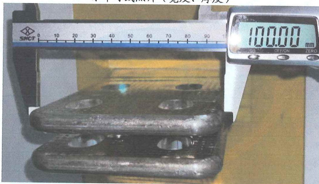
水平母线照片（宽度、厚度）
