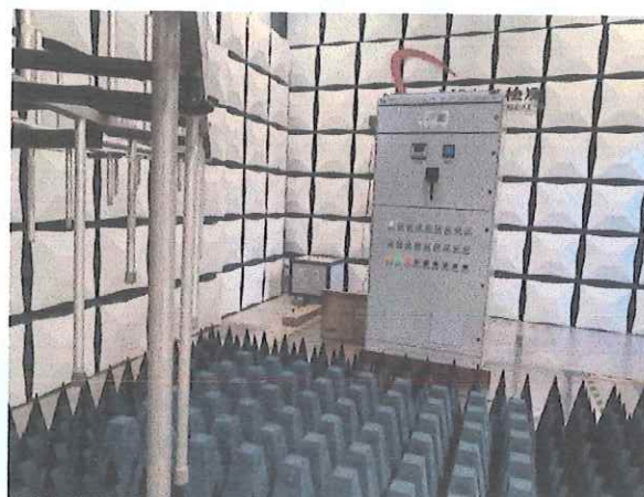
射频电磁场辐射抗扰度试验布置图
