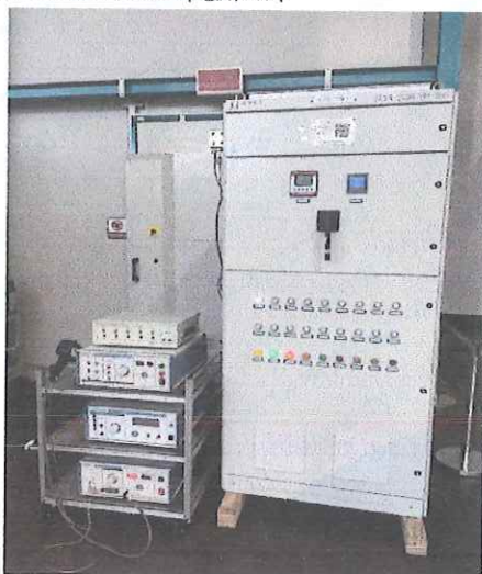
静电放电抗扰度试验布置图
