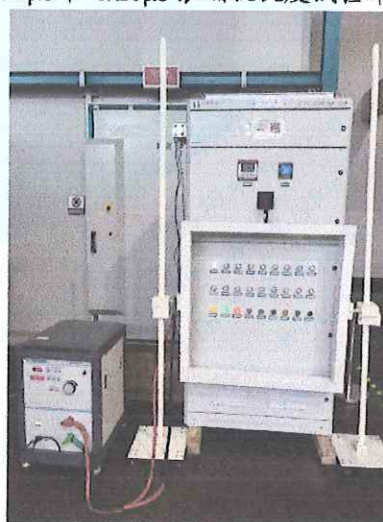
工频磁场抗扰度试验布置图
