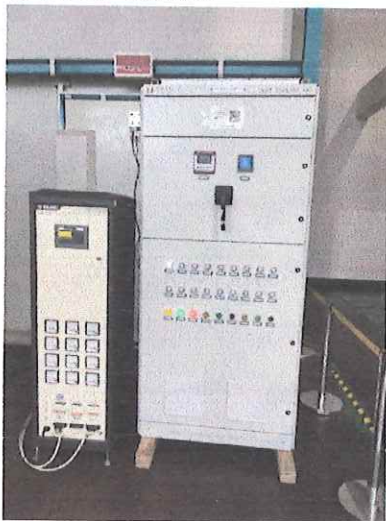
电压暂降和短时中断抗扰度试验布置图
