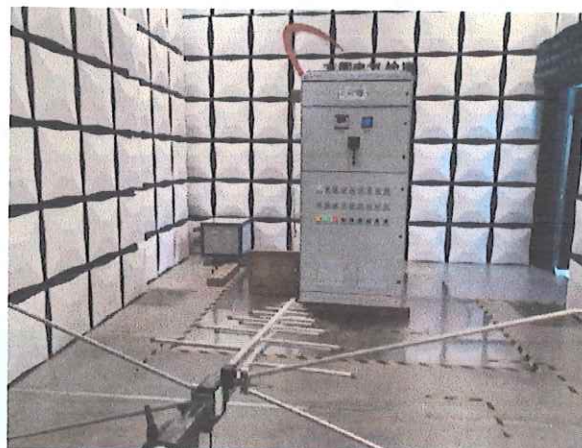
电场辐射发射试验布置图
