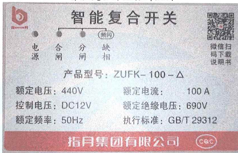
智能复合开关铭牌照片
