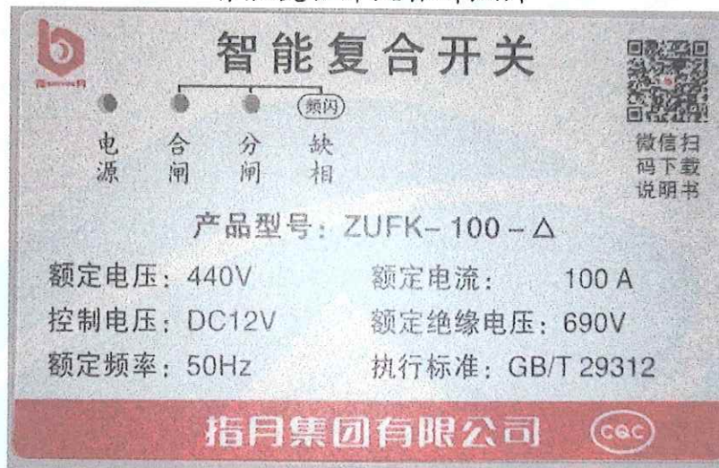
智能复合开关铭牌照片
