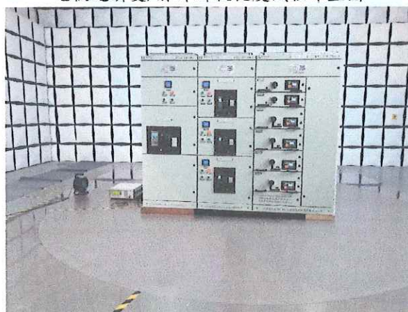
射频传导抗扰度试验布置图
