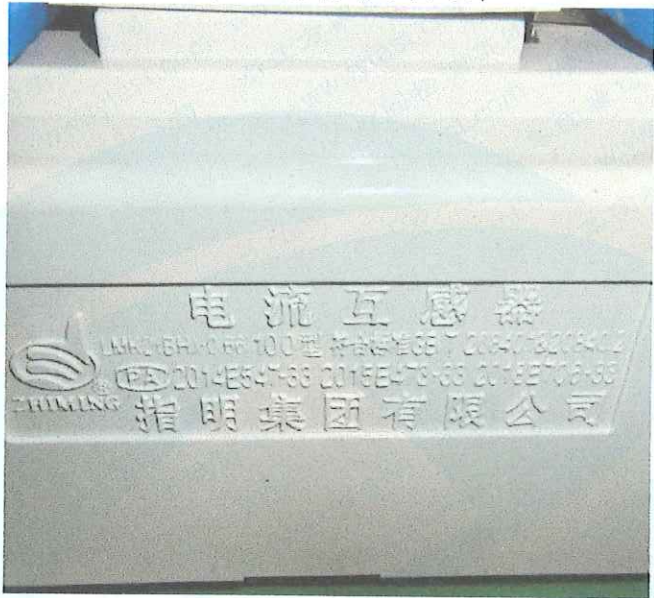
电流互感器铭牌照片
