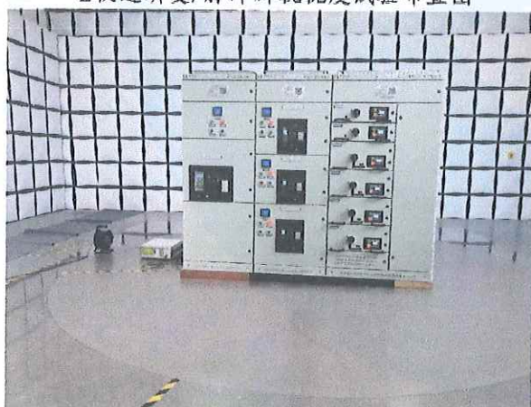
射频传导抗扰度试验布置图
