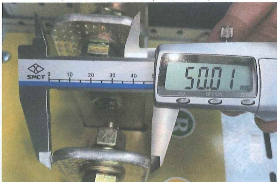
方案4 开关进出线照片（宽度、厚度）
