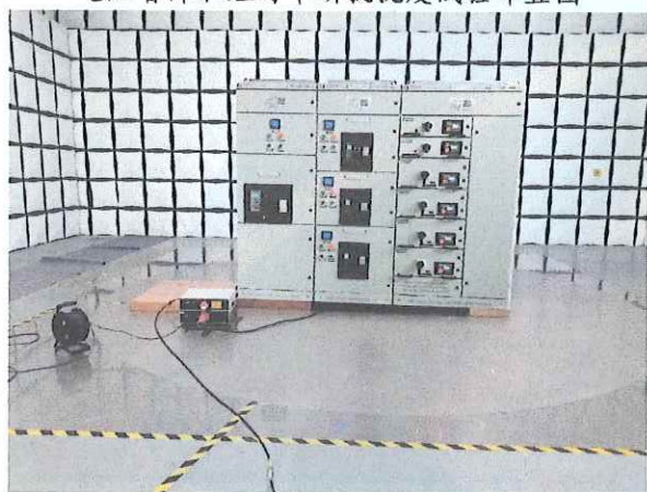
传导发射试验布置图
