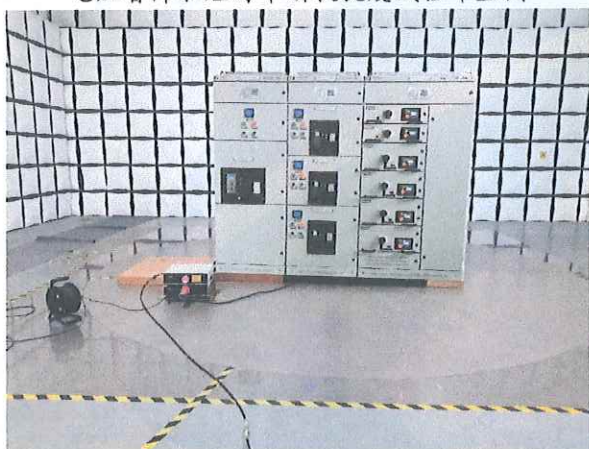
传导发射试验布置图
