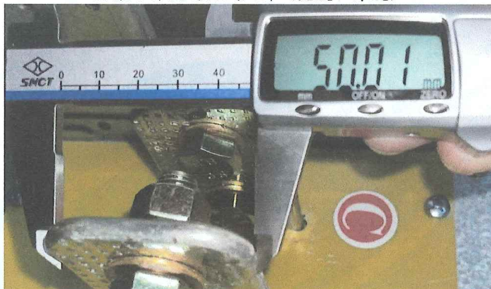
方案 4 开关进出线照片（宽度、厚度）
