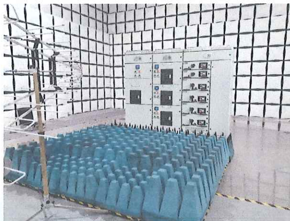
射频电磁场辐射抗扰度试验布置图
