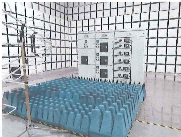
射频电磁场辐射抗扰度试验布置图
