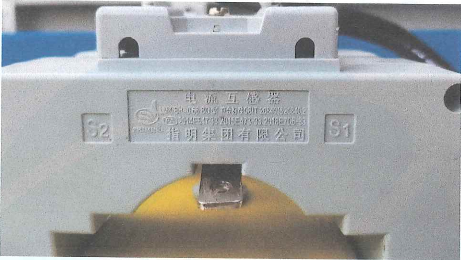
电流互感器铭牌照片
