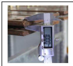
主开关进出母线
